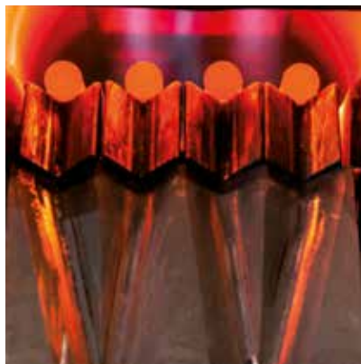
Billettes chauffées à 800 °C
